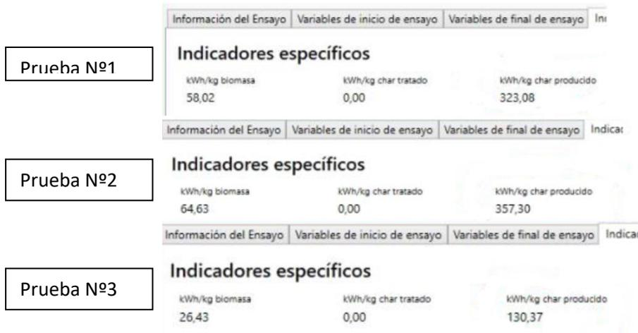
**Figura 12. Indicadores específicos obtenidos por sistema SCADA Fuente ITE.**
