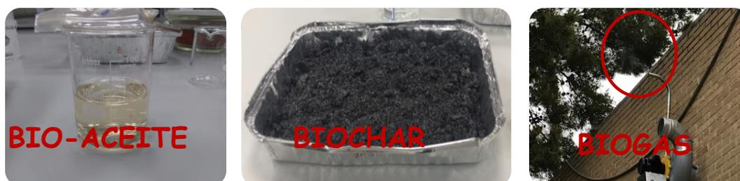
**Figura 7. Imagen de los productos obtenidos en el ensayo de carbonización de biomasa en la planta de pirolisis CIRCULARCARBON.**
