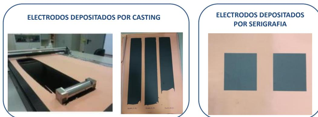
**Figura 8. Imágenes de los electrodos de char de astilla de pino depositados por serigrafía y por casting**
